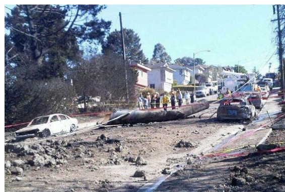
爆発地点のクレーターと破断した配管 論点No.59-18
