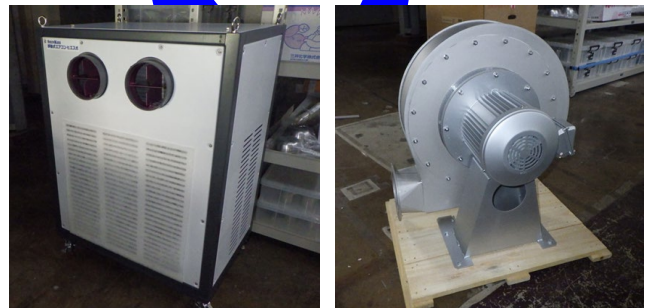
【スポットクーラ、仮設送風機の製作状況】
