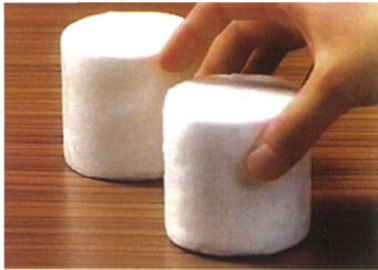
ガラス原料(ガラスファイバークार्टリッジ) ⇒高放射性廃液をしみ込ませて溶融炉に供給
