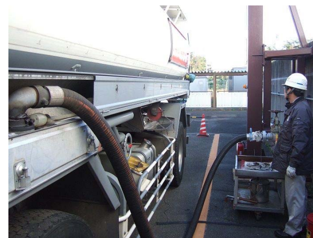
タンクローリーによる発電所への燃料受入状況 (平成23年当時の写真ではない)
