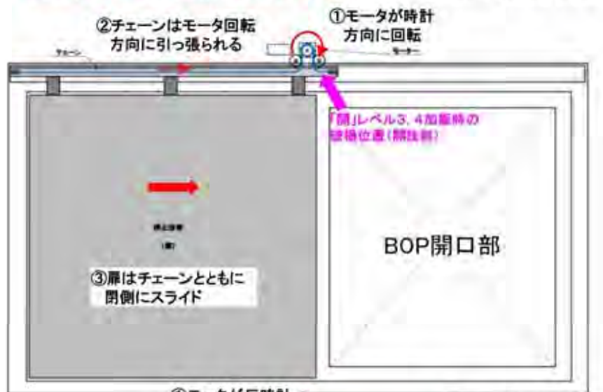
扉開状態レベル3加振後のチェーンの状態(6月20日)
