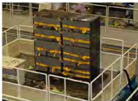
可搬型設備の加振試験
