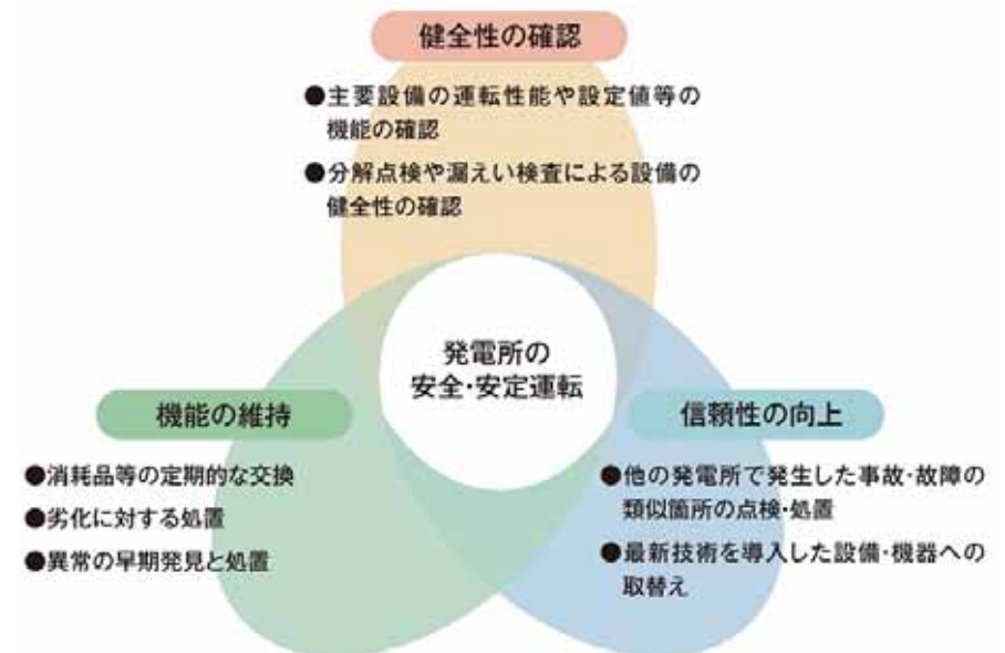
原子力発電所の定期検査の目的
