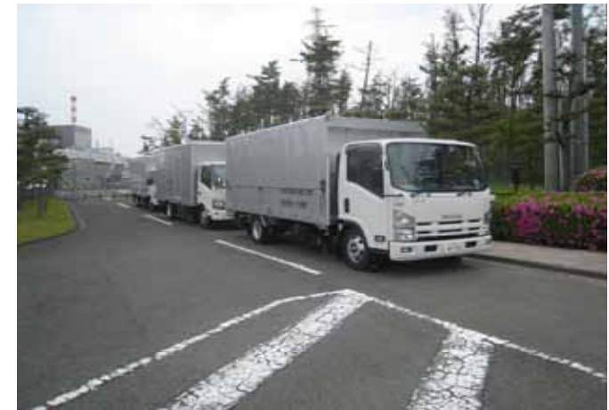
可搬型代替低圧電源車
