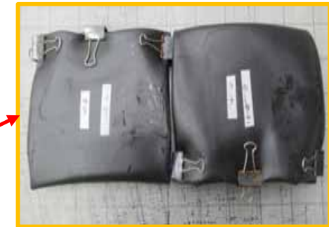
促進耐候性試験の試験体 (土木シートを遮光シートで包んでる状態)
