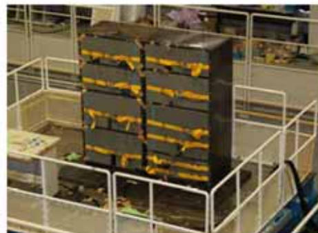
可搬型設備の加振試験
