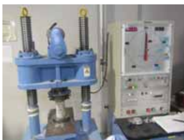
①強度の点検状況 (耐圧試験機による圧縮強度試験)
