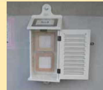
飛来塩分捕集器 (ドライガーゼ法)
