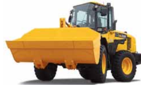
ホイールローダ (重大事故等対処設備) ※ バケット容量:2m 3 けん引力:86kN 配備数:2台(予備3台)
