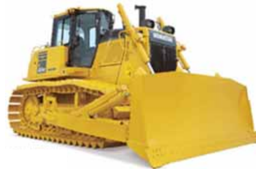
ブルドーザ (自主対策設備) ※ けん引力:284.4kN 配備数:1台
