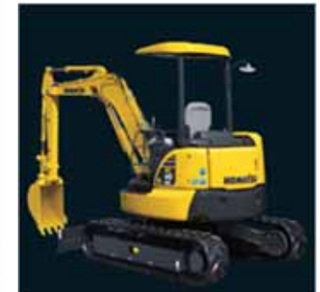
油圧ショベル (自主対策設備) ※ バケット容量:0.16m 3 最大掘削力:39kN 配備数:1台
