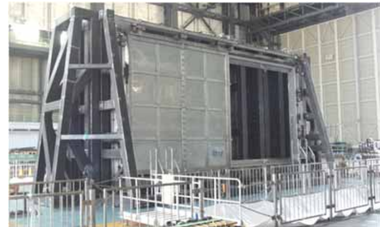
ブローアウトパネル閉止装置加振試験装置
