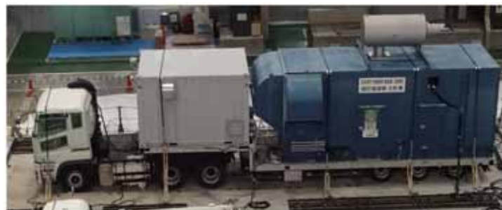
常設代替高圧電源装置加振試験装置
