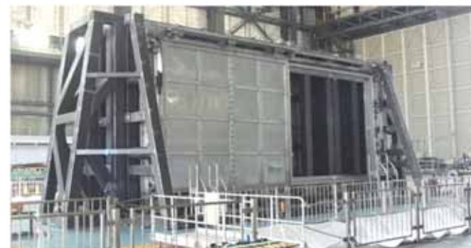
ブローアウトパネル閉止装置加振試験装置
