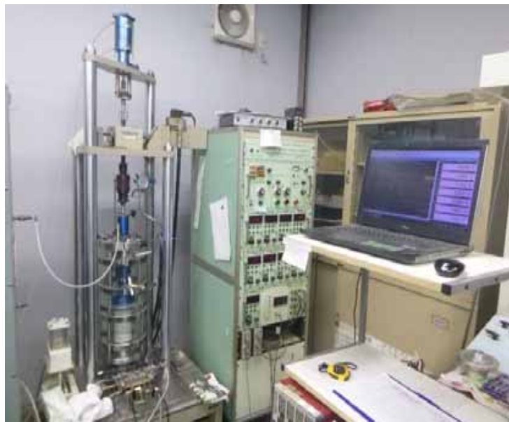
液状化強度試験状況 (中空繰返しねじりせん断試験)
