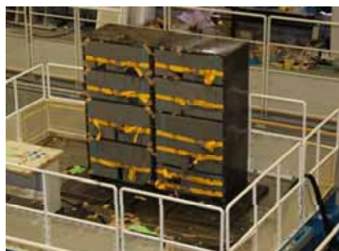
可搬型設備の加振試験
