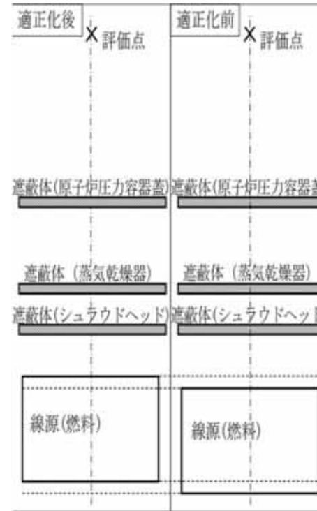
図-1 燃料の線量率計算モデル
