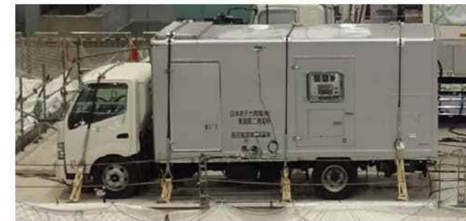
(a) 機能確認済加速度確認のための加振試験状況
