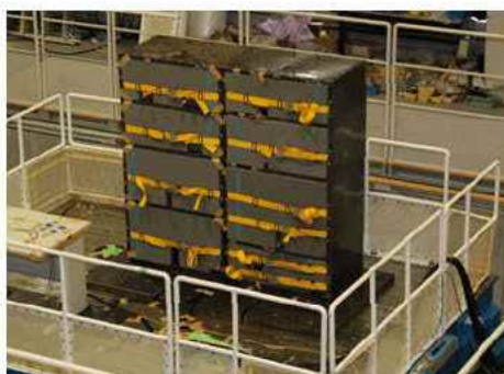
可搬型設備の加振試験
