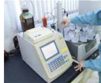
塩分浸透の点検状況 (塩化物イオン含有量試験)
