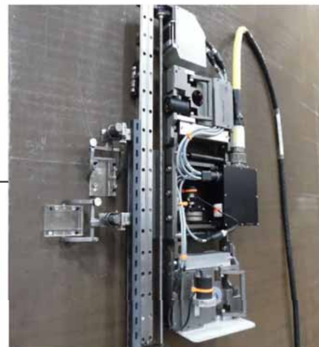
RPV 自動 UT 装置 (モックアップ試験時撮影)
