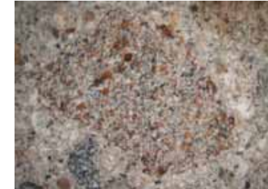
アルカリ骨材反応の点検状況 (実体顕微鏡観察)
