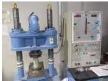
強度の点検状況 (耐圧試験機による圧縮強度試験)
