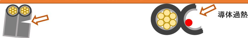
④急速な過熱により被覆部が発煙、損傷した。
