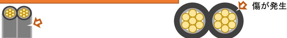
②電源コードの傷の部分に外力が加わり導線の断面積が減少
