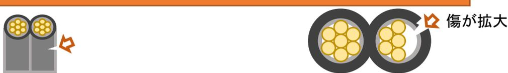
③事象発生直前、通電により導線部に電流が集中して流れたことにより急速に過熱
