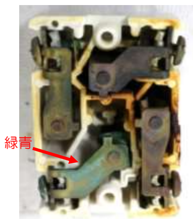
図 2-9 コンセント内部の電極の状況
