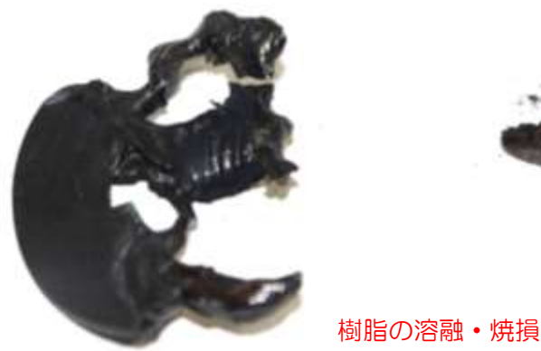
図2-3 プラグのカバー樹脂の状況
