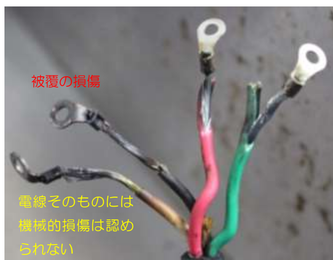
図 2-7 プラグ内部の電極に接続する配線
