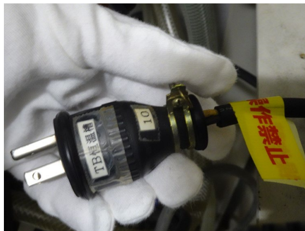
写真 4-2 発災した恒温槽の主電源のコンセント引抜の状況
