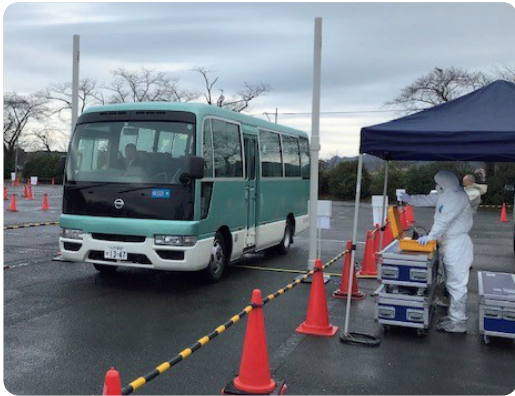
ゲート型モニタによる車両検査
