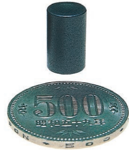
ペレット(ウラン燃料を焼き固めたもの)
