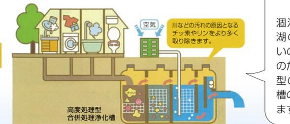
霞ヶ浦流域にお住まいで浄化槽を新たに設置する場合は、窒素とリンを除去できる高度処理型の合併処理浄化槽の設置が義務付けられています。
