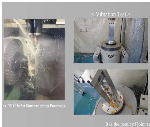
図 超小型人工衛星筐体 試作&振動評価
