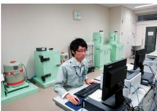
試料中に含まれるβ線やγ線を出す放射性物質を測定します。α線を出す放射性物質は、**α線測定室**で測定します。
