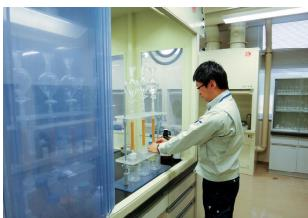
透過力の弱いβ線を放出するストロンチウムなどの測定のため、試料から目的の元素を化学分離します。排水や環境試料に含まれるブルトニウムは、**ラジオアイソトープ室**で化学分離します。
