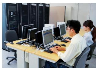
中央監視局の中枢部で、測定局のデータを収集、保存するシステムです。解析装置・市町村・ホームページへのデータ送信や、線量率上昇時に通報する機能も搭載しています。
