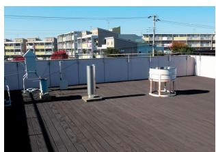
雨水、降下塵、大気浮遊塵を採取する機器を設置しています。
