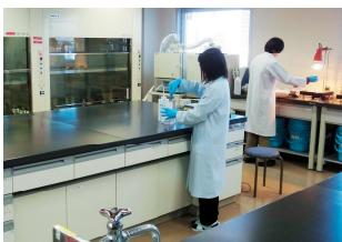
採取した環境試料の前処理（海産物・野菜の洗浄、細断等）を行います。続いて隣の**試料灰化室**で乾燥・灰化を行います。
